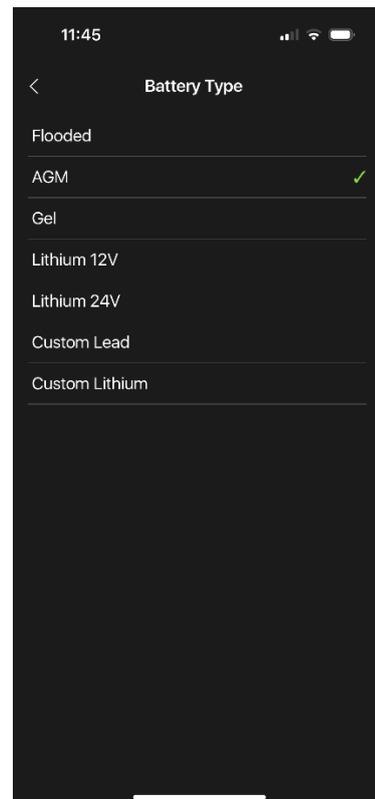
Si l'un des types de batterie sélectionnables par défaut ne répond pas à vos besoins, il est possible de créer votre propre type de batterie ou programme de charge.
