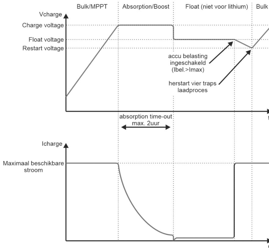
In de Bulk/MPPT-fase levert de acculader de volledige beschikbare uitgangsstroom en stuurt gewoonlijk ongeveer 80 % van de lading terug naar de accu, zodra de laadspanning is bereikt. Tijdens deze fase werkt de lader in MPPT-modus, waarbij maximaal PV-vermogen naar de accu wordt overgebracht.
